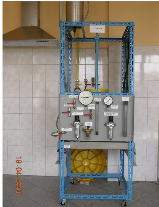
FIG.4 PHOTO OF THE TEST STAND FOR TESTING ATOMIZERS [3]
