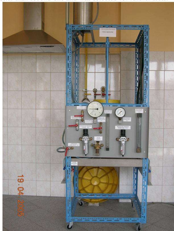
FIG.4 PHOTO OF THE TEST STAND FOR TESTING ATOMIZERS [3]
